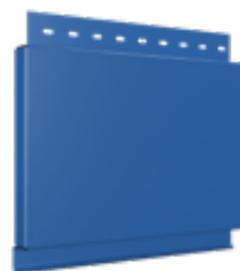
**Фасадная кассета** - облицовочный материал, внешне представляет собой загнутую по торцам, завершённую металлическую конструкцию. Наши фасадные кассеты без прослойки из полимера и имеют группу горючести НГ (негорючие). Они могут быть как штучными (в виде квадрата, прямоугольника или П-образными, Г-образными), так и погонажными.
