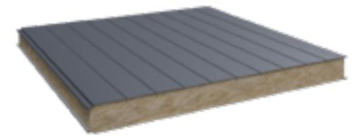
Применяются для строительства наружных стен, межкомнатных перегородок. Для облицовки используются гладкие листы или профилированные. Стеновые ТСП скрепляются между собой специальным Z-замком, обеспечивающим высокую плотность стыка. Поэтому в этих местах не требуется использование дополнительных облицовочных покрытий, нащельников и доборных элементов.
