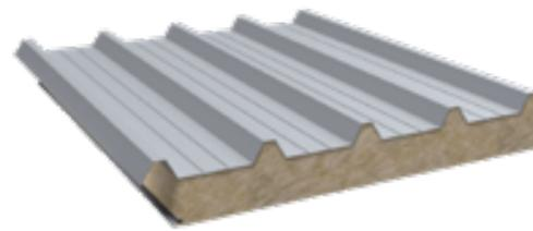
Ребра жёсткости из высокого трапециевидного профиля увеличивают прочность панелей и выполняют функцию верхней металлической обшивки. Для кровельных панелей используется утеплитель большей плотности - не менее 105 кг/м<sup>3</sup> (согласно ТУ и ГОСТ).
